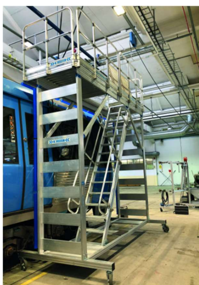
Figura 16 – Plataforma lateral para mantenimiento.
